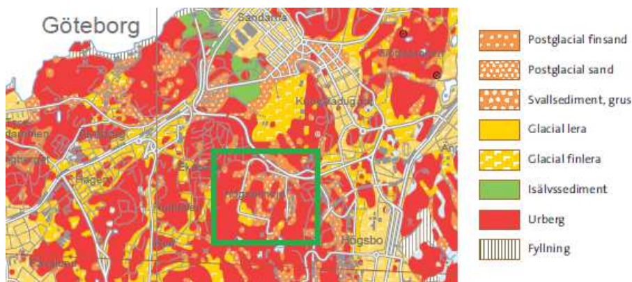
Figur 3. Jordartskarta från SGU. Grön markering visar områdets lokalisering. © Sveriges geologiska undersökning (SGU)
